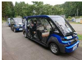
1人の遠隔監視・操作者が 3台の無人自動運転車両を運行
